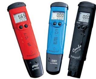
Máy đo pH (đỏ), máy đo EC (xanh), máy kết hợp đo pH và EC (đen)
