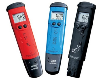
Máy đo pH (đỏ), máy đo EC (xanh) và máy đo cả pH và EC (đen)
